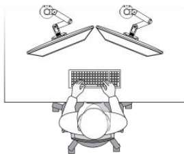
Afbeelding 2: opstelling met twee beeldschermen, waarbij het tweede beeldscherm meer dan een derde van de tijd wordt gebruikt (Afbeelding Bakker Elkhuizen).
